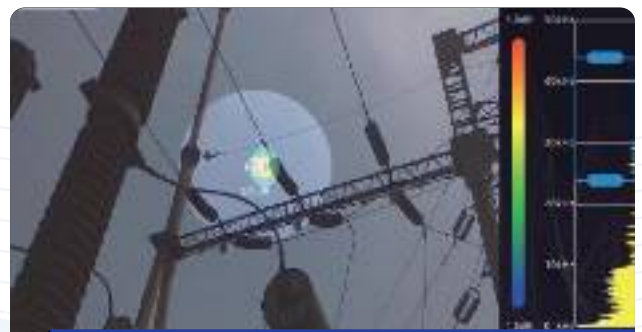
绝缘子尖端放电
