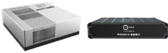
原理：采用深度卷积神经网络算法实现音频事件的识别分类
