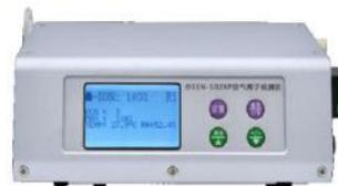
原理：圆筒电容式传感器
