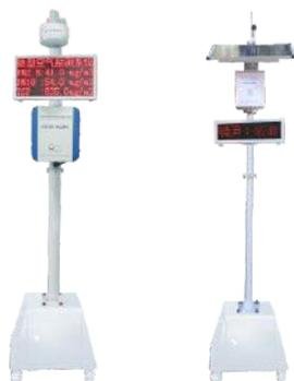
原理：激光散射、电化学、PID
