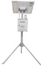
土壤监测参数：土壤氮磷钾、土壤温湿度、土壤电导率、土壤PH值
